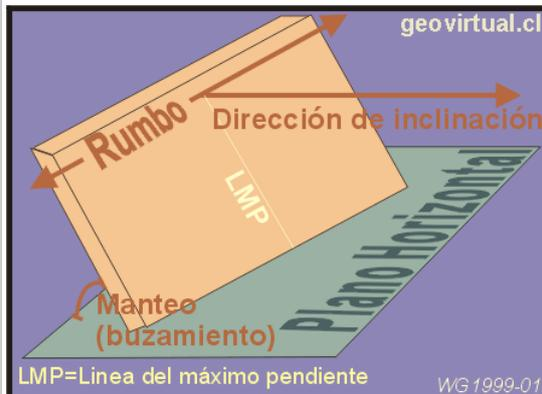
Para definir la orientación de un plano se necesita la dirección de inclinación y el manteo; o el rumbo, manteo y la dirección de inclinación. La dirección de inclinación (ingl. Dip Direction) marca hacia donde se inclina el plano, o la proyección horizontal de la línea del máximo pendiente. El rumbo es la línea horizontal de un plano (véase abajo). El manteo o buzamiento (ingl. dip) mide el ángulo entre el plano y el plano horizontal.
