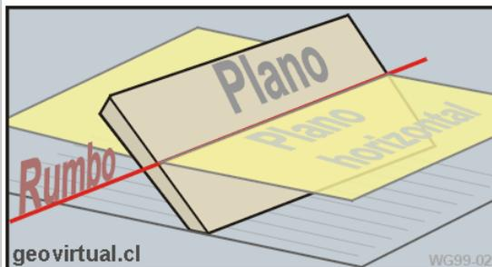
El rumbo se puede definir como línea que resulta por la intersección del plano geológico por un plano horizontal. Se puede imaginarse una superficie de agua (que es siempre horizontal), se hunde el plano hasta la mitad, la línea hasta donde se mojó el plano será el rumbo.
