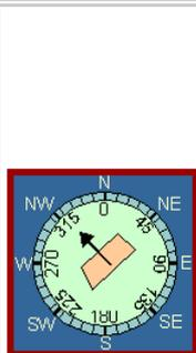
El tipo de notación más fácil y más eficiente. Solo dos números permiten la descripción y definición de cualquier plano. El primer número (ejemplo: 320/...) es la dirección de inclinación (dip direction), el valor azimutal en grados (°) hacia donde el plano se inclina. Un plano con inclinación hacia el norte entonces tiene 0° hacia al este corresponde a 90°; hacia al sur 180°; hacia oeste=270°. Entonces el primer número (la dirección de inclinación) puede llegar hasta 360°.
