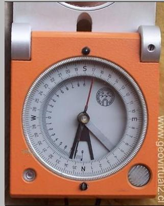
La brújula del tipo "Freiberger" mide en una acción la dirección de inclinación y el manto. Tiene una escala azimutal (contrarreloj), un botón para fijar la aguja y una escala del manto con escala roja y negra. Las mediciones de este tipo de brújula son de alta confiabilidad y este brújula es fácil para usar.
