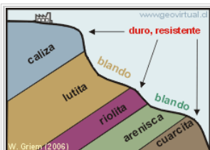
Figura: La erosión diferencial: El desgaste se manifiesta más fuerte en rocas de menor resistencia. Las diferencias entre distintas litologías pueden ser muy pequeñas, pero suficiente para modelar un talud irregular.
