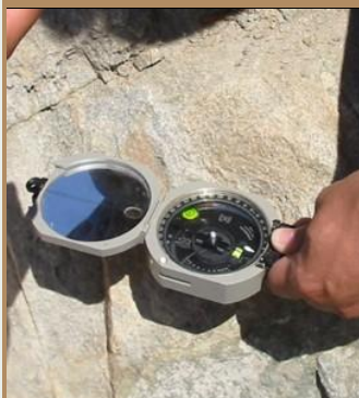
Uso de la brújula Brunton - medición del rumbo
